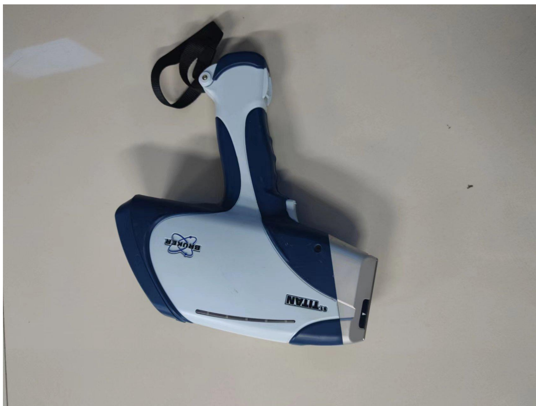
图5-2 S1 TITAN X射线荧光分析仪
