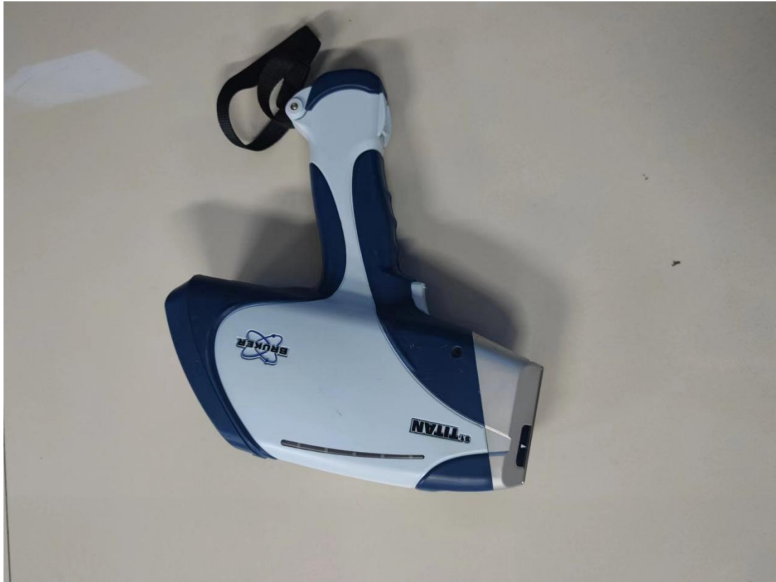
图 5.3.1-1 S1 TITAN X 射线荧光分析仪
