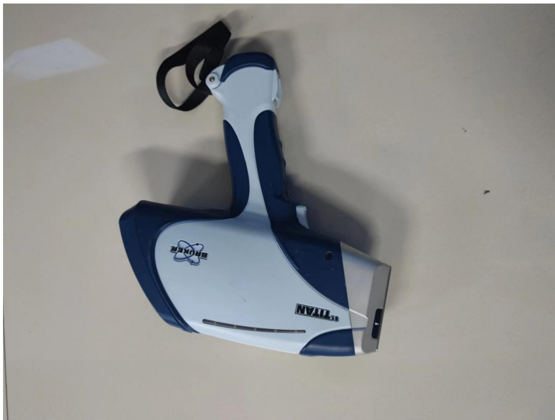
图5-2 S1 TITAN X射线荧光分析仪
